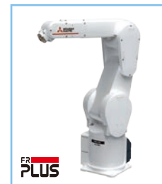
RV-7FR/7FRL-D/Q/R 最大可搬运重量:7 kg 臂长:713/908 mm
