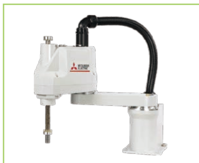
RH-3CRH4018-D 最大可搬运重量:3 kg 臂长:400 mm
