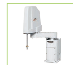
RH-3FRH35/45/55**-D/Q/R 最大可搬运重量:3 kg 臂长:350/450/550 mm
