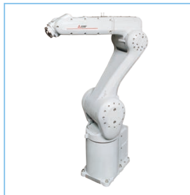
RV-8CRL-D 最大可搬运重量:8 kg 臂长:931 mm
