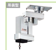
RH-3FRHR35**-D/Q/R 最大可搬运重量:3 kg 臂长:350 mm 上下行程:150 mm 洁净(ISO 5级)、防水(IP65) 上下行程:120 mm
