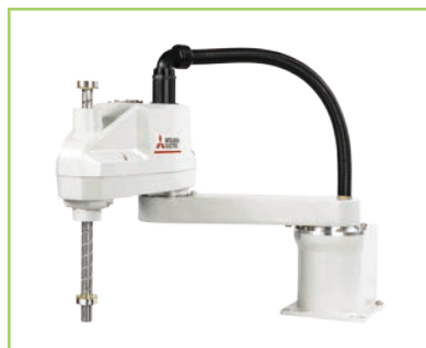
RH-6CRH6020/7020-D 最大可搬运重量:6 kg 臂长:600/700 mm
