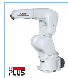
RV-20FR-D/Q/R 最大可搬运重量:20 kg 臂长:1094 mm
