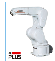
RV-13FR-D/Q/R 最大可搬运重量:13 kg 臂长:1094 mm
